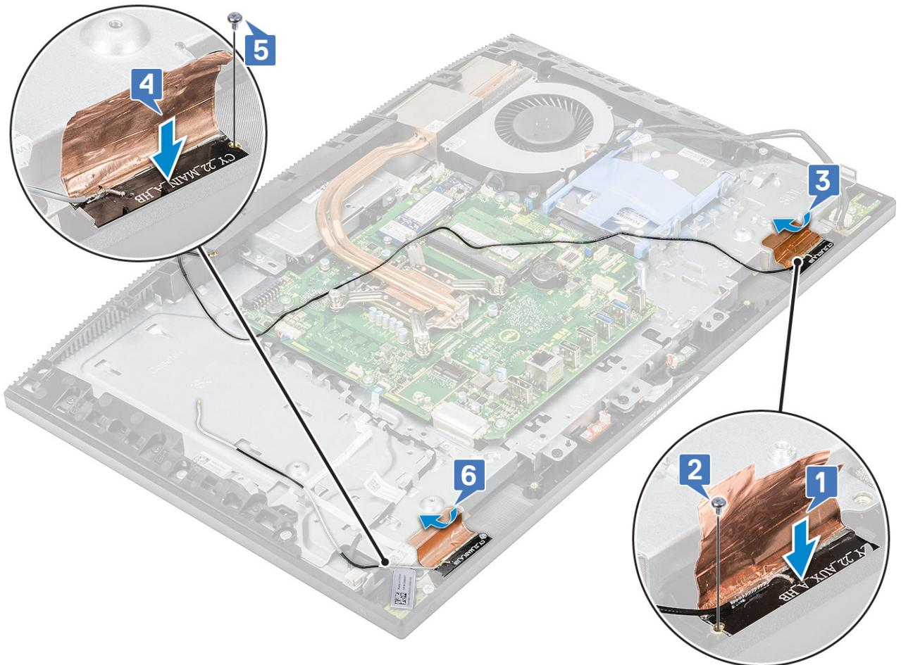
d 穿过显示屏面板底座上的布线导轨布置天线缆线 [1,2]。
