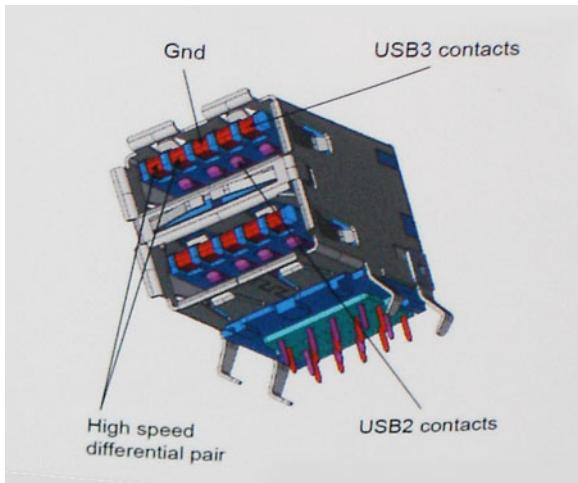
随着当今时代高清视频内容、TB 容量存储设备、高像素数码相机等对数据传输速率的要求不断提高，USB 2.0 的速度可能跟不上时代了。另外，没有 USB 2.0 连接可达到接近 480Mbps 的理论最大吞吐量，数据传输速率大约为 320Mbps (40MB/s)，这是实际运用的最大值。同样，USB 3.0/USB 3.1 Gen 1 连接也永远达不到 4.8Gbps。我们很可能看到实际运用的最大速率是 400MB/s。在此速度下，USB 3.0/USB 3.1 Gen 1 的速度比 USB 2.0 提升 10 倍。
