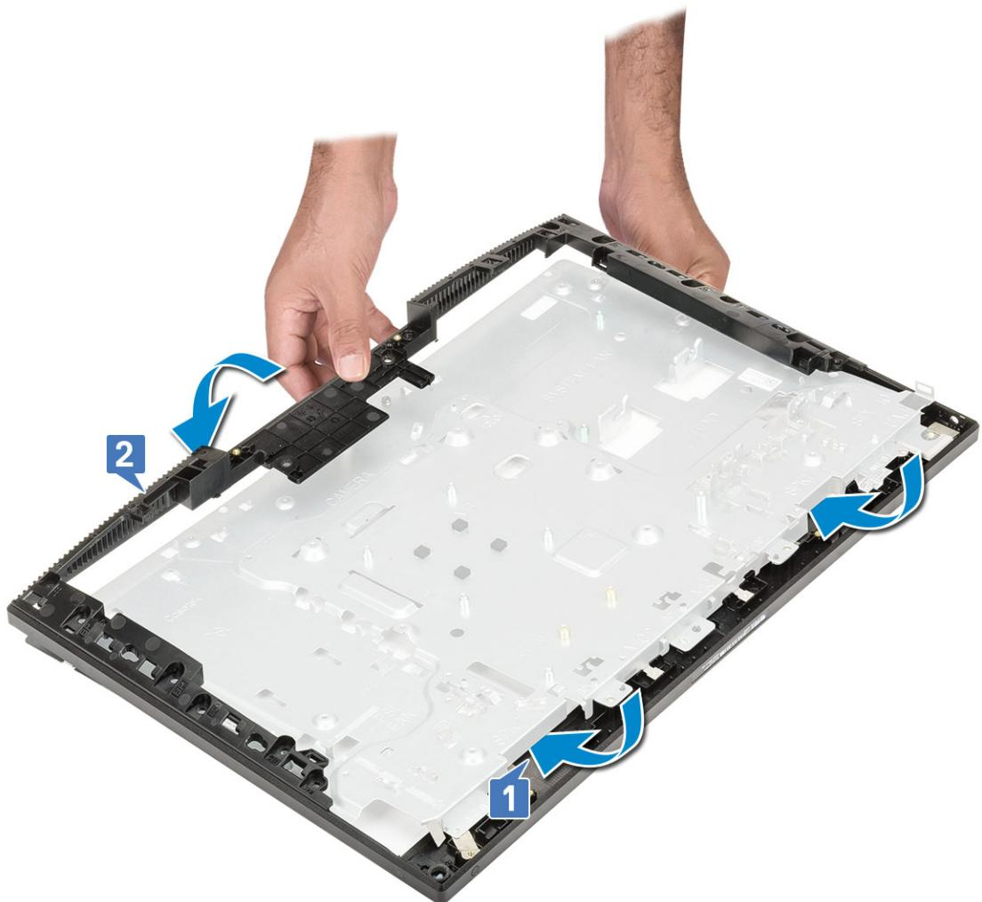
2 拧上将中框固定至显示屏部件底座的 11 颗螺钉 (M3x5) [2]。
