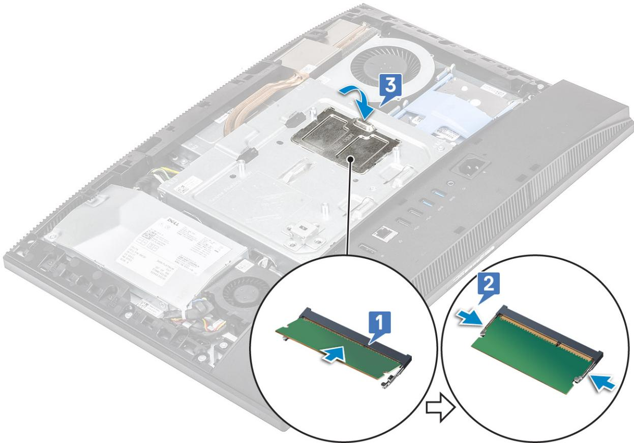
3 将 DIMM 盖板上的卡舌与系统板护罩上的插槽对齐，然后将其卡入到位。
