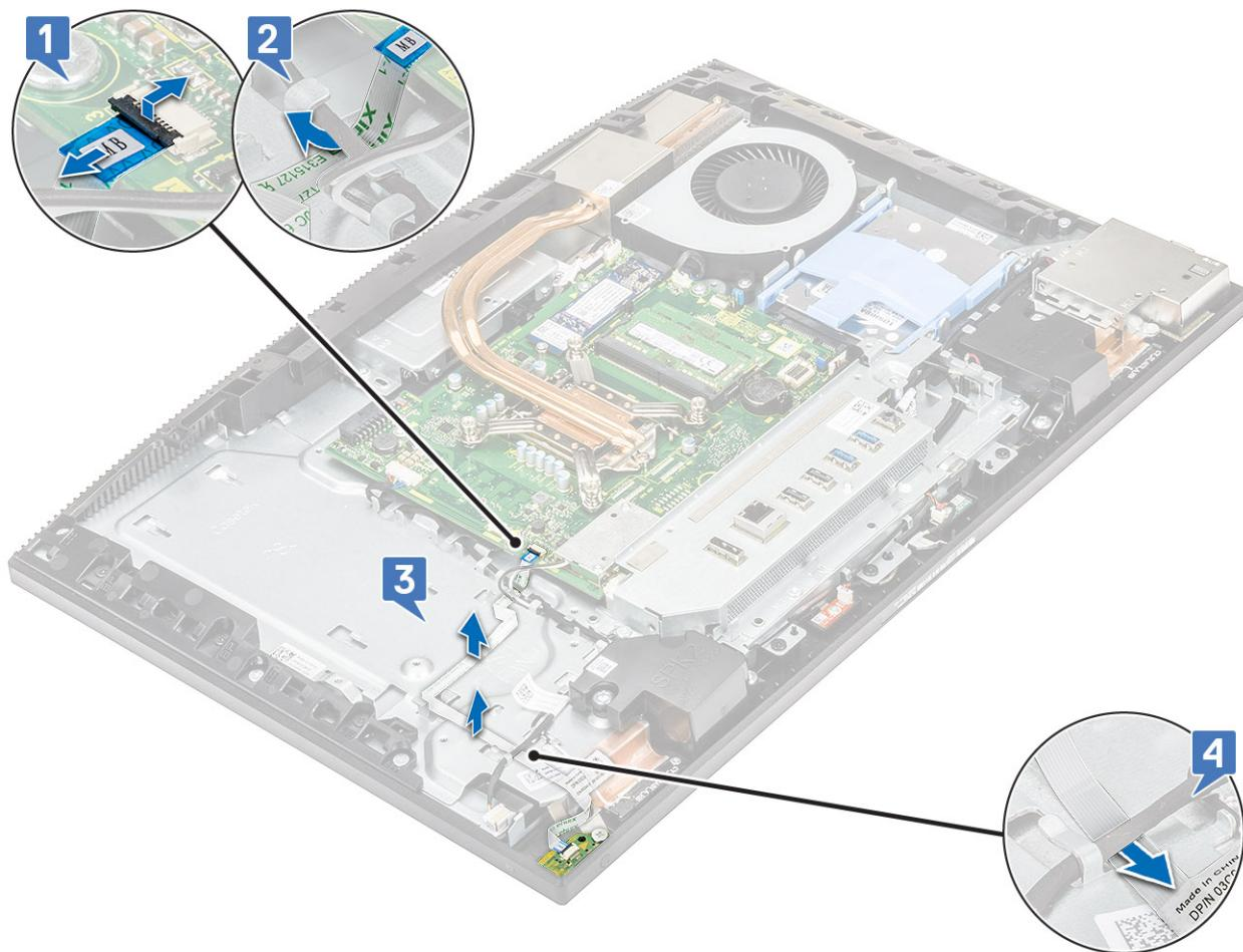
e 拧下将电源按钮板固定至中框的一颗螺钉 (M3x5) [3]。
